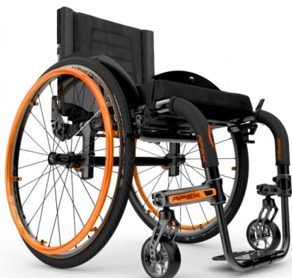
Modèle similaire à l'APEX C avec un châssis en aluminium et carbone. La combinaison de l'aluminium et du carbone permet d'obtenir une excellente robustesse tout en conservant une légèreté incomparable.
